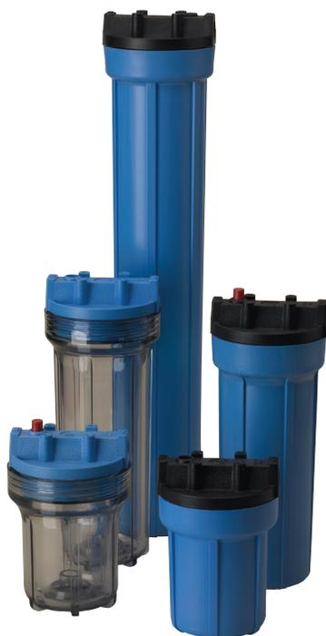
Les boîtiers de filtre Slim Line<sup>®</sup> Pentair sont disponibles en polypropylène renforcé ou en styrène acrylonitrile (SAN) transparent, en longueurs de 5 po, de 10 po et de 20 po. Les bouchons de boîtiers en polypropylène renforcé noirs ou bleus sont disponibles avec des raccords de 1/4 po, de 3/8 po ou de 1/2 po NPT. Quatre bossages sont moulés dans chaque bouchon à des fins de fixation.
