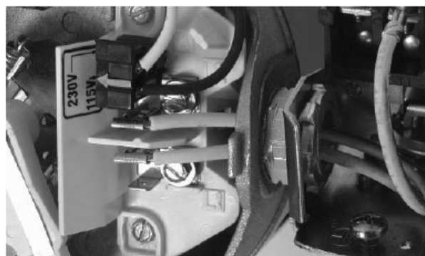
Figure 7 : Tension réglée à 115 V, type de prise
