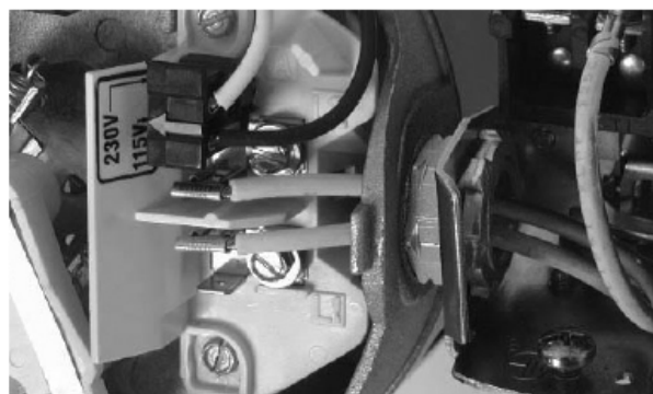
Figura 7: Configure el voltaje en 115 V, tipo interruptor
