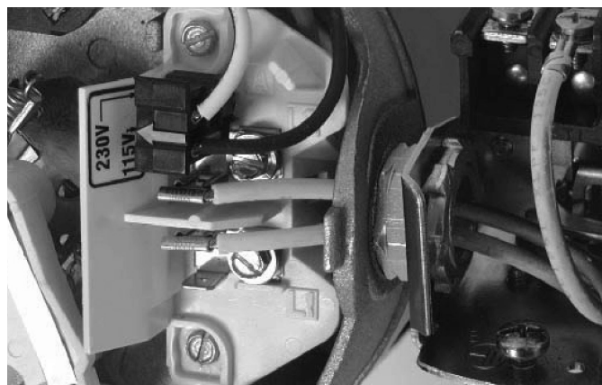
Figure 9 : Tension réglée à 115 volts, type de fiche
