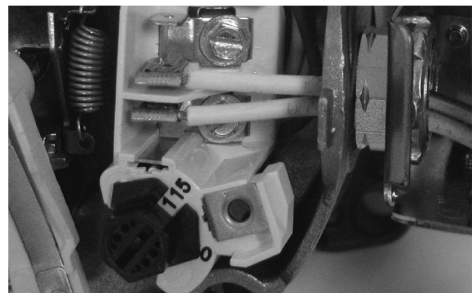
Figura 11: Voltaje configurado a 115 voltios, tipo dial
