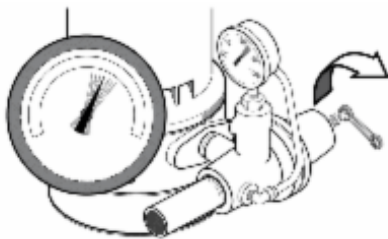
Figure 14B : Observer l'oscillation du manomètre
